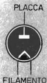
A destra il simbolo di un diodo munito di catodo. Nel primo caso il filamento funge anche da catodo, mentre nel secondo caso esso funge soltanto da elemento riscaldante.
