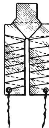
stori si usano resistenze da 1/4 watt e da 1/2 watt; nei ricevitori a valvole si usano resistenze da 1/2 watt e da 1 watt e, talvolta, una o più resistenze di valore superiore a 1 watt; le resistenze di valore superiore a 1 watt non sono più di tipo chimico, bensì a filo.
