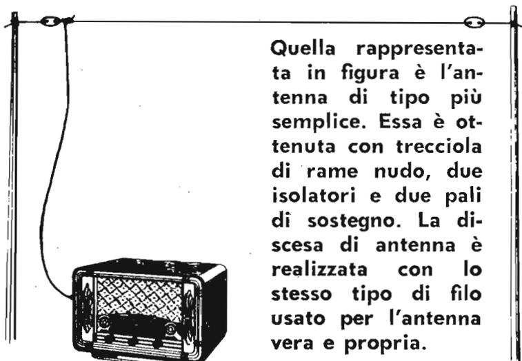
Quella rappresentata in figura è l'antenna di tipo più semplice. Essa è ottenuta con trecciola di rame nudo, due isolatori e due pali di sostegno. La discesa di antenna è realizzata con lo stesso tipo di filo usato per l'antenna vera e propria.
